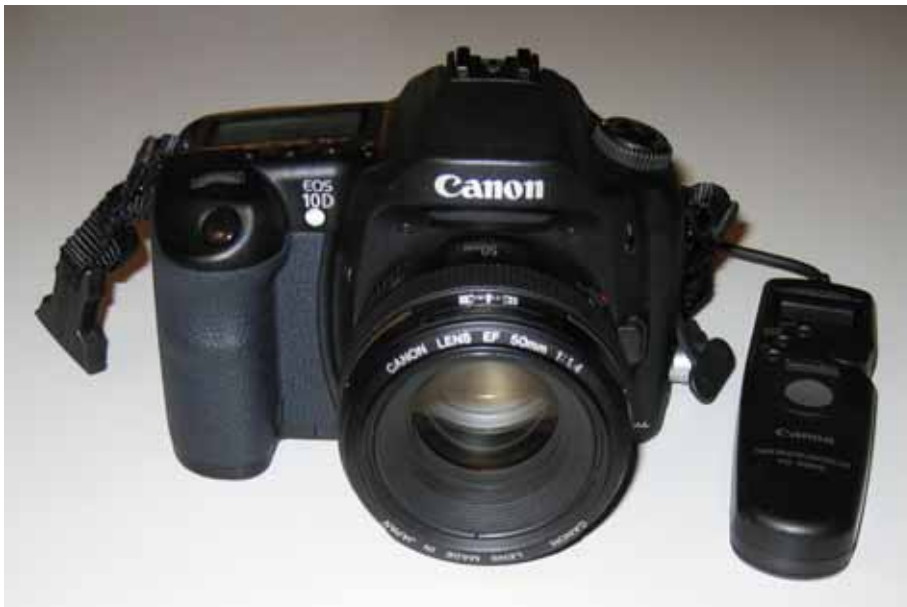
Abb. 1: Die Canon EOS 10D mit Timer-Auslösekabel TC-80N3
